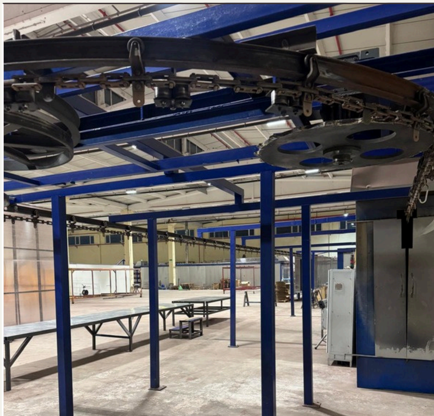
Ligne de pulvérisation entièrement automatisée.
