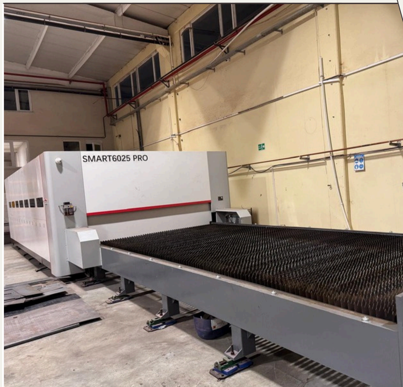
SMART PRO 6025 Table double pour la découpe laser de tôles
