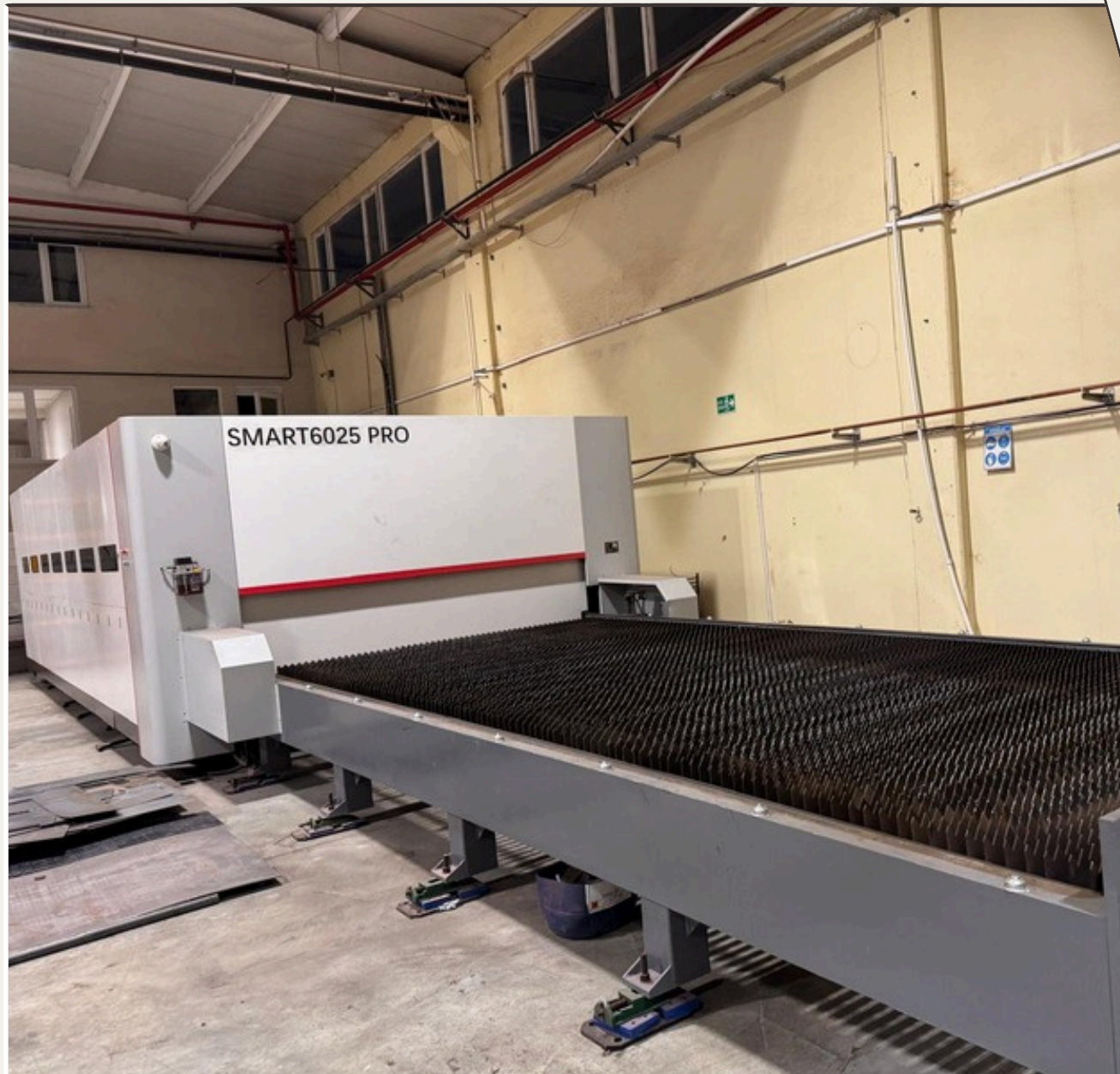
SMART PRO 6025 Double Table Sheet Metal Laser
