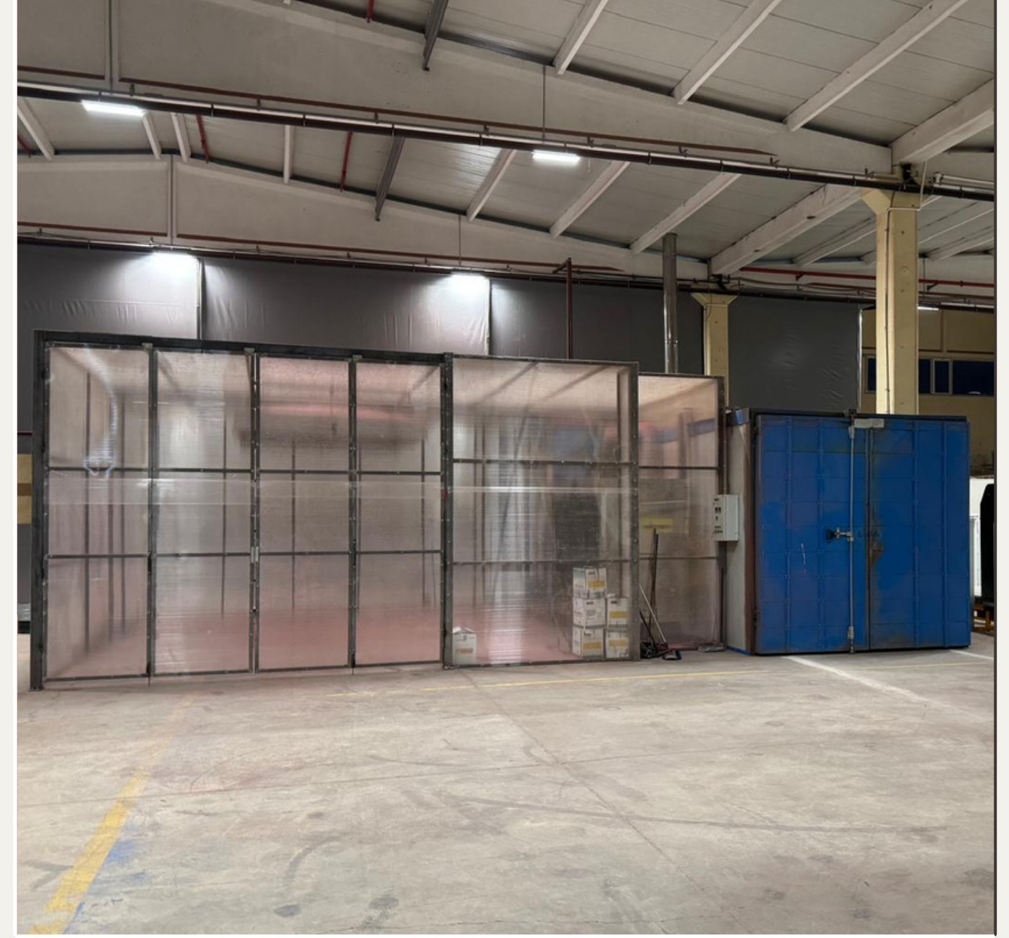
8mt x 3mt x 3mt ebatlarında Geniş Hacimli Ürünler için Toz Boyama Ünitesi
