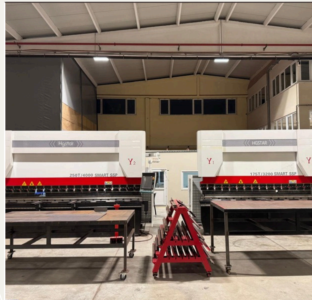
CNC ABKANTBIEGUNGEN 4000 mm 250 Tonnen 3200 mm 175 Tonnen
