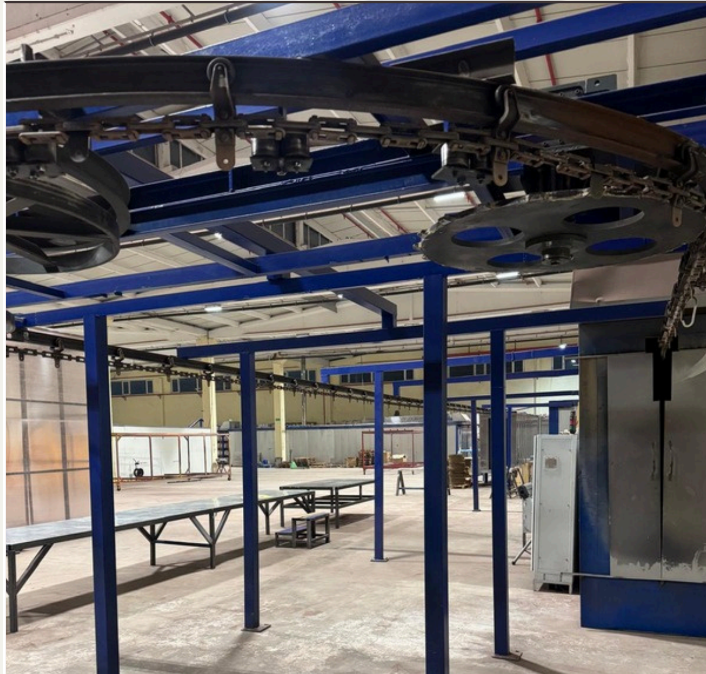
Vollautomatische Sprühanlage 170 m Schiene, Hängeförderanlage
