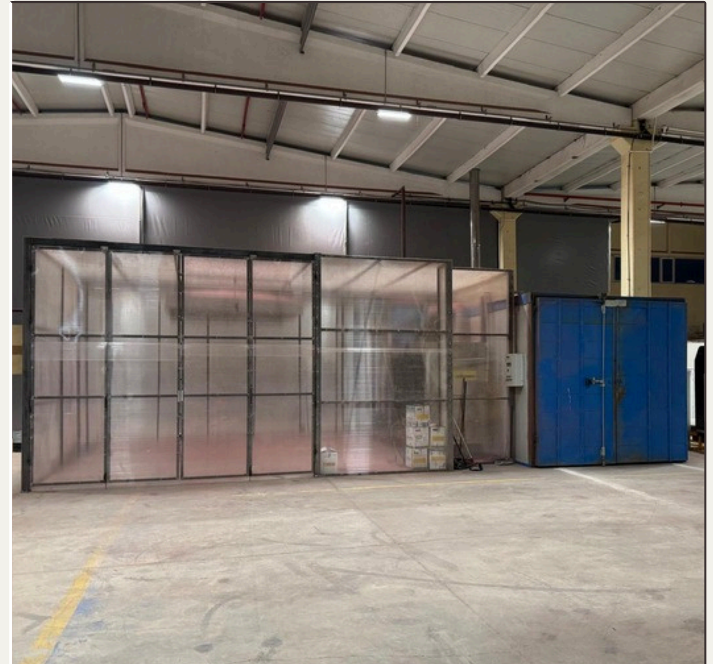
Pulverbeschichtungsanlage für Großserienprodukte mit den Maßen 8 m x 3 m x 3 m.
